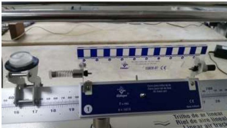
Figura 1 - Montagem para alinhamento do trilho, utilizando carrinho e suporte com nível de bolha.
