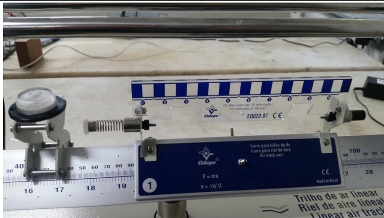
Figura 2 - Montagem para alinhamento do trilho, utilizando carrinho e suporte com nível de bolha.
